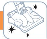
**HR** Za čišćenje glave najprije skinite držač navlaka za brisač poda, a zatim glavu s tijela uređaja. Operite je vodom iz slavine i po potrebi upotrijebite spužvu Ostavite je da se potpuno osuši 24 sata prije ponovnog postavljanja.
